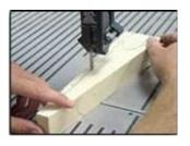
FIGURE 2 BAND SAW ROUGH SHAPING A  $CO_2$  CAR
