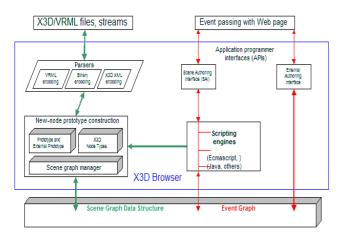
FIGURE 6 X3D SYSTEM ARCHITECTURE
