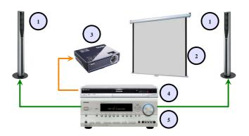
$FIGURE\ 1$   $AV\ SYSTEM\ FOR\ VIDEO\ PROJECTION$   $1-SOUND\ SYSTEM,\ 2-SCREEN,\ 3-DATA\ PROJECTOR,$   $4-DVD\ PLAYER,\ 5-AV\ SWITCHER/AMPLIFIER$
