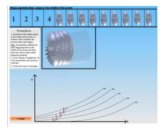
FIGURE 2 VIRTUAL ASSEMBLY MODULE OF A 13-STAGE AXIAL COMPRESSORS
